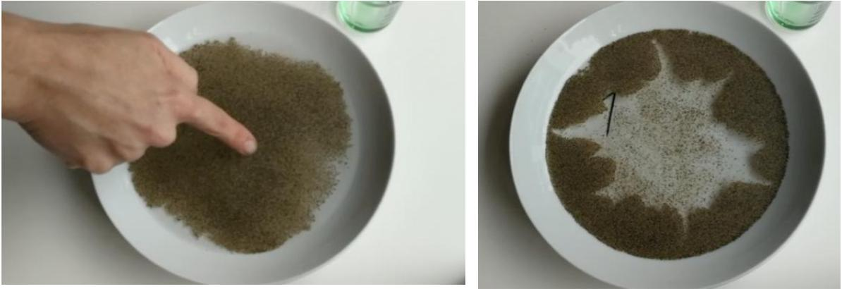
Imagen 8. Disminución de la tensión superficial al tocar con jabón el centro de un plato con agua y pimienta.
