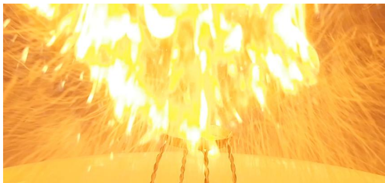
Imagen 4. Gotas de aceite ardiendo empujadas por agua en forma de vapor
